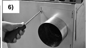
6) Montieren Sie das Außensicherungsblech mit Hilfe der Schrauben mit denen der Außensicherheitsdeckel befestigt war
