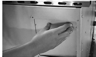
Entfernen Sie das Blech unter dem Deckel indem Sie auf die schwächste Verknüpfung drücken
