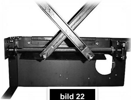
Als erstes muss geprüft werden, ob nur das Gitter festgeklemmt ist. Das Gitter aus dem Kessel herausnehmen und den
