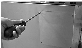
Entfernen Sie die Außenschutzdeckel mit Hilfe eines Schraubenziehers
