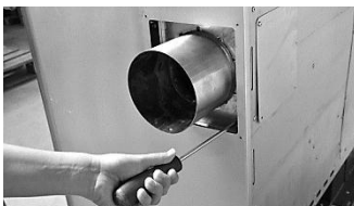
Montieren Sie die Gleitrosette mit Hilfe der Schrauben mit denen der Innensicherheitsdeckel befestigt war
