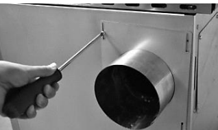
Montieren Sie das Außensicherungsblech mit Hilfe der Schrauben mit denen der Außensicherheitsdeckel befestigt war
