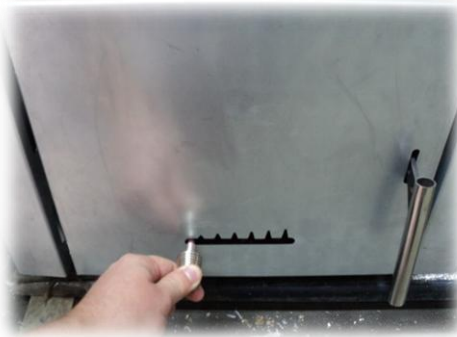
zatvoren ulaz primarnog zraka
